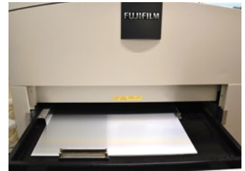
Bild links: Der Autoloader zum Fuji-Thermalplattenbelichter. Als System brauchen sie ihren Platz.
