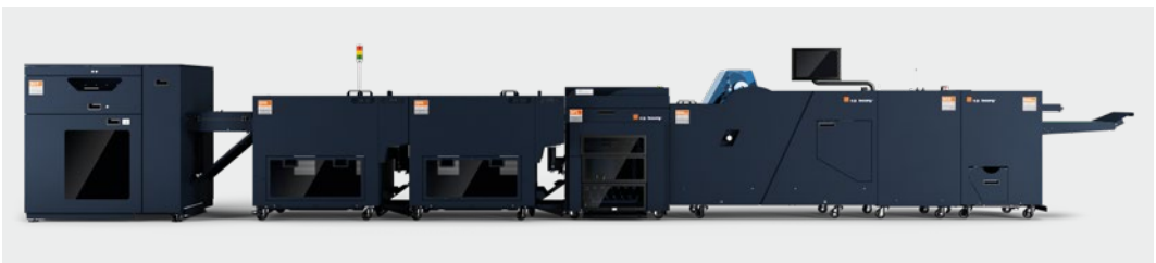
Hochautomatisierte Produktionslinie für die Broschürenfertigung, mit dem BBM 40/60+ als zentralem Element.
