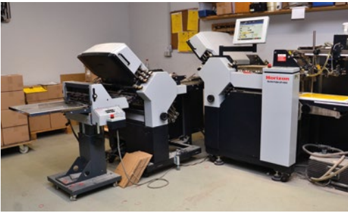
Ebenfalls im Einsatz bei Nötzold: das Sechs-Taschen-Falzsystem AF-406S („Buckle Folder“) für Kleinstfalzungen.
