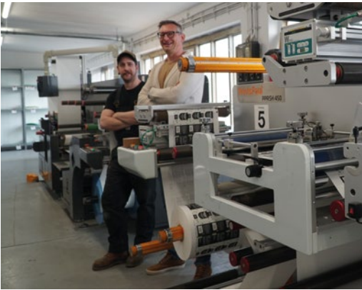
Alexander Weber und Paul Arndt an der Produktionsstraße für Multilayer-Etiketten. Vorne der Laminator Kurt 450, hinten der Starliner mit dem Flexodruckwerk.
