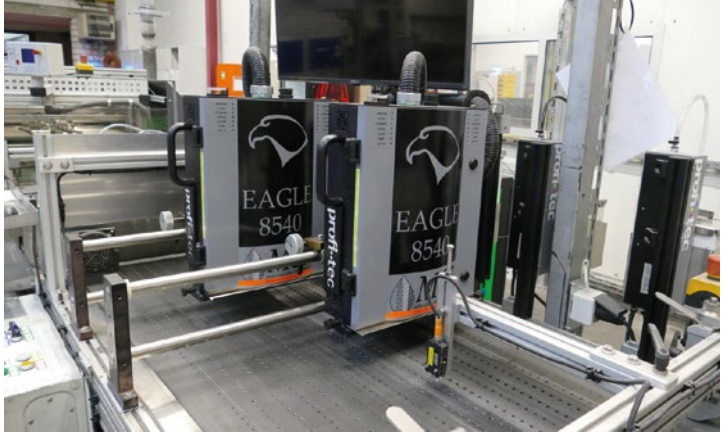
Erstens: Mit zwei Hybrid-Köpfen MCS Eagle 8540 (à 216 mm Druckbreite) von profi-tec ist seit Juli 2025 ein fest installiertes Highspeed-Inkjetsystem ausgerüstet.
