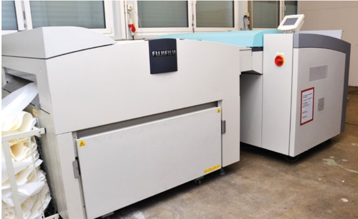
Bild links: Der Autoloader zum Fuji-Thermalplattenbelichter. Als System brauchen sie ihren Platz.
