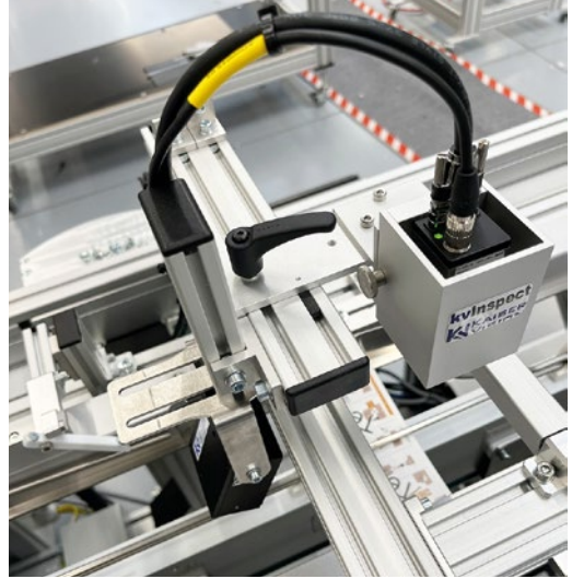
Die Inspektionssysteme kvInspect im Einsatz an einer Kraus-Zusammentraglinie für Leaflets und Booklets.
