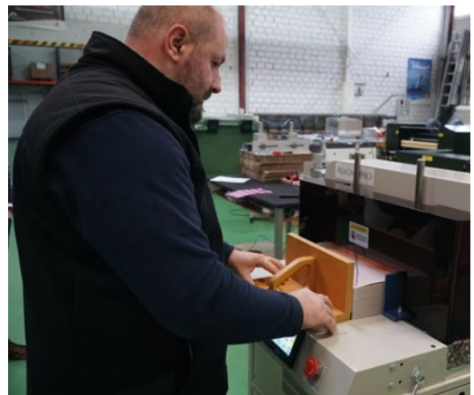
Produktionsführer Jasmin Mimidinowski demonstriert hier, wie der 100D Pro funktioniert. Von links und rechts wird der Stapel von zwei beweglichen Backen gehalten.
