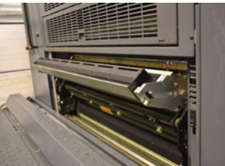
Bild rechts und Mitte: Die Farbmessersteuerung: Schnittstelle zur Inline-Farbmessung für konstante Druckqualität im Fortdruck. Bild links: Das LED-UV-Trocknersystem ermöglicht die sofortige Weiterverarbeitung der Druckbögen.
