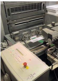
Schnelle Produktion: Bis zu 13.000 bedruckte Kuverts pro Stunde sind möglich.
