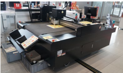
Schneiden und Drucken gleichzeitig geht nicht auf einem Schneidplotter? „Klar geht das“, sagt Andreas Graf von dmsDigital (rechts), hier mit Matthias Siegel von der Grafischen Palette, und stellte auf der PDC den Sinajet DF1007-MT Plus mit zusätzlichem Inkjet-Druckkopf vor (unten).
