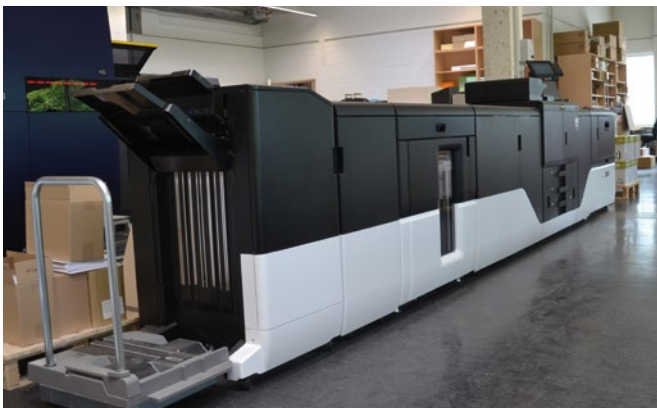
Die Kyocera TASKalfa Pro 15000c verarbeitet auch hohe Auflagen im Bogendruck vollautomatisch (l.). Blick in den Papierlaufweg: Da keine heißen Fixierwalzen benötigt werden, bleibt die Materialbelastung minimal (oben).
