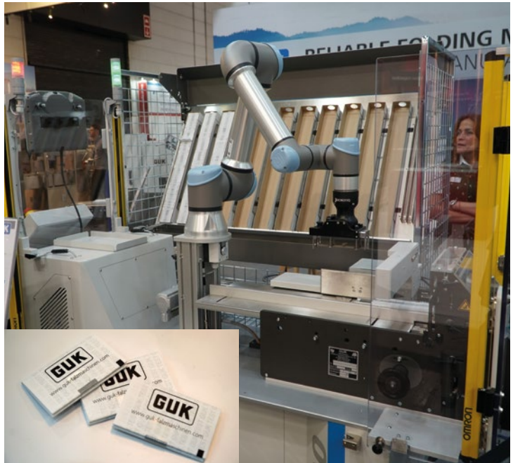
Das PPcobo in Action. Die flexibel einsetzbare Lösung entnimmt hier fertig gefaltete Packungsbeilagen und platziert sie selbsttätig in die entsprechenden Trays. Ein Bediener ist dafür nicht mehr erforderlich.
