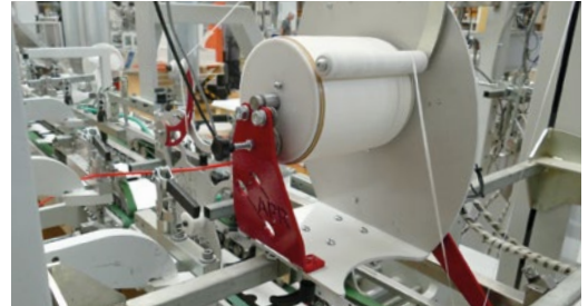
Auch der Aufspendekopf für die Aufreißhilfen in Kartonverpackungen oder Kuverts befindet sich derzeit hier.
