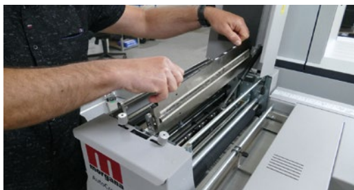
Der Werkzeugtausch am AutoCreaser Pro XL geht schnell von der Hand. So kann zugleich auch perforiert werden.
