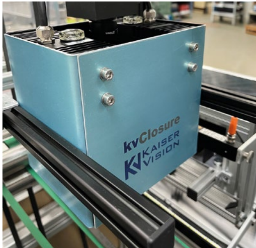
Die Inspektionslösung kvClosure im Praxiseinsatz.
