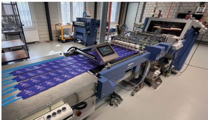
Die neue Auslage Bograma SAB 600 S kombiniert erstmals Schuppen und Spreizen in einem durchgängigen Arbeitsschritt – für effizientere Inlineprozesse.
