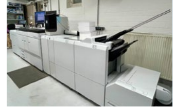
Die Fujifilm Revoria Press EC2100S von hinten mit der Rückstich-Finishingeinheit für schnelle Lösungen.
