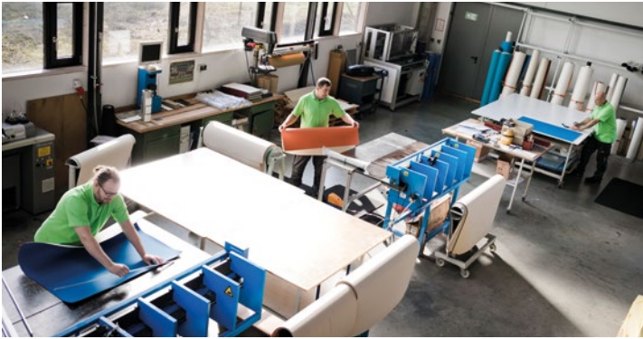
In der modernen Produktionsstätte werden jährlich ca. 500.000 Produkte unter Einsatz neuester CAD-Systeme und Zünd-Plotter exakt nach Vorgaben verarbeitet.
