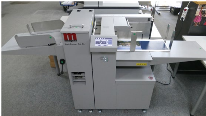
Der Riill- und Perforierautomat Morgana AutoCreaser Pro XL ist die neueste Anschaffung bei PMLS aus dem Hause Mehring. Er verarbeitet bis zu 8.500 Bg/h.
