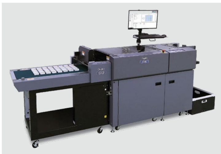
Der Multifinisher FKS/Duplo DocuCutter DC-648 mit integrierter Auslage DC-ST100 (links). Die Auslage ist vor allem geeignet für Druckdienstleister, die jeden Tag große Mengen kleinformatiger Printprodukte produzieren müssen.
