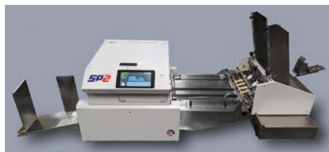
Das Drucksystem Astrojet SP2 von Astro Machine bringt hochwertigen Vierfarbdruck auf triste Versandumschläge und kann auch inline positioniert werden.
