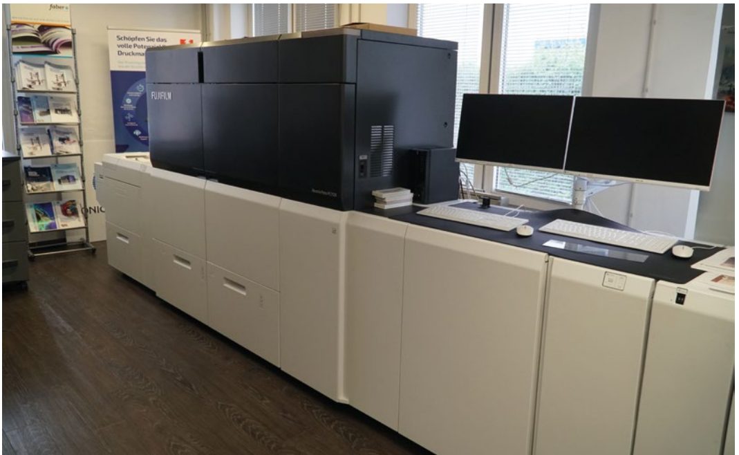
Die Revoria Press PC1120, hier im Faber-Showroom, ist das aktuelle Topmodell des Herstellers im Toner-Bereich. Die Maschine kann mit bis zu sechs Farbstationen bestückt werden und ermöglicht damit zahlreiche Anwendungen.
