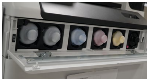
Die Farbraumerweiterung mit Pink als fünfter Farbe (Kartusche ganz rechts) kommt Thiele besonders bei der Reproduktion lebensechter Hauttöne zugute.
