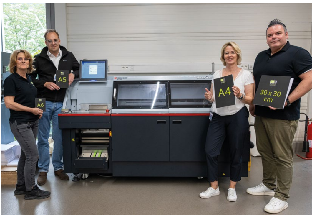
Vom Taschenbuch bis zum Großformat: Der Horizon iCE Binder BQ-300 verarbeitet Buchformate von A6 bis 30 × 30 cm. Im Bild (v.l.): Limego-Mitarbeiterin Martina Lucassen (Produktionsleitung), Jan Gesterkamp (Vertrieb Steuber), Britta Dannenberg (Verkaufsleiterin Steuber) und Limego-Vertriebsleiter Dirk Reinhardt.
