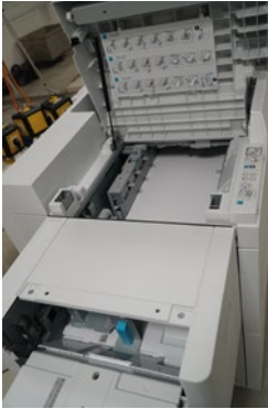
Der Langanleger für Bögen bis 660 mm ist ideal für die Mappenproduktion.
