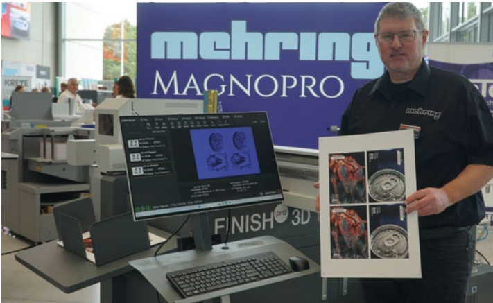
Andreas Mehring zeigte auf der PDC als Deutschland-Premiere den Skandacor FinishPro 3D 1623, ein digitaler UV-Spotlack-Drucker mit breitem Anwendungsspektrum. Er kann feine Texturen ebenso wie 500-Mikron-Effekte realisieren.
