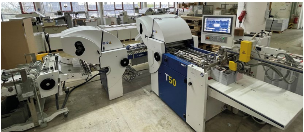
Die MBO T50 im Halbformat 50 x 70 cm: Steuber lieferte die Taschenfalzmaschine als Gebrauchtmaschine – nach einer Generalüberholung durch MBO arbeitet sie bei Wahl Druck in Aalen wie neu.
