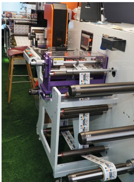
Das auf der interpack erstmals gezeigte vierfarbige Inkjet-Eindrucksystem von PrintsPaul – hier auf der Plattform Markus 370 – verwendet Druckköpfe von Epson.
