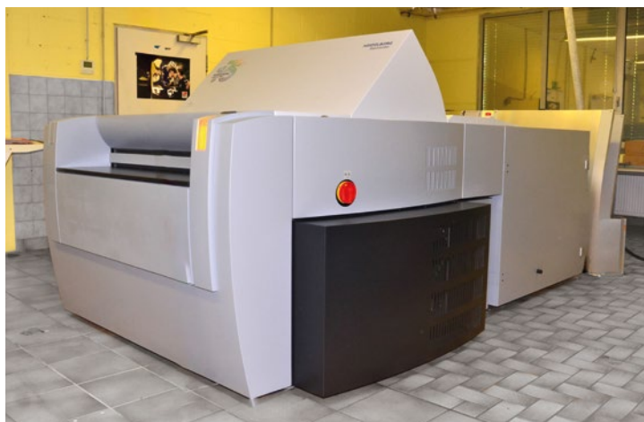
Der neue Heidelberg Suprasetter bei Repa Druck in Saarbrücken ist der erste seiner Art im Südwesten, der mit einer vollautomatischen Plattenzuführung (CPL) direkt von der Palette arbeitet.
