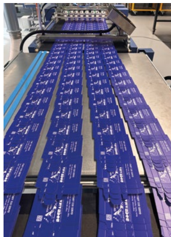
Die neue Auslage Bograma SAB 600 S kombiniert erstmals Schuppen und Spreizen in einem durchgängigen Arbeitsschritt – für effizientere Inlineprozesse.
