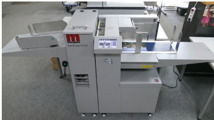
Der Riill- und Perforierautomat Morgana AutoCreaser Pro XL ist die neueste Anschaffung bei PMLS aus dem Hause Mehring. Er verarbeitet bis zu 8.500 Bg/h.
