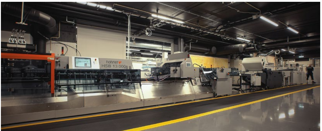
...mit dem vollautomatisierten Sammelhefter HSB Digi 13.000 als Kernelement bei einer skandinavischen Mediengruppe.
