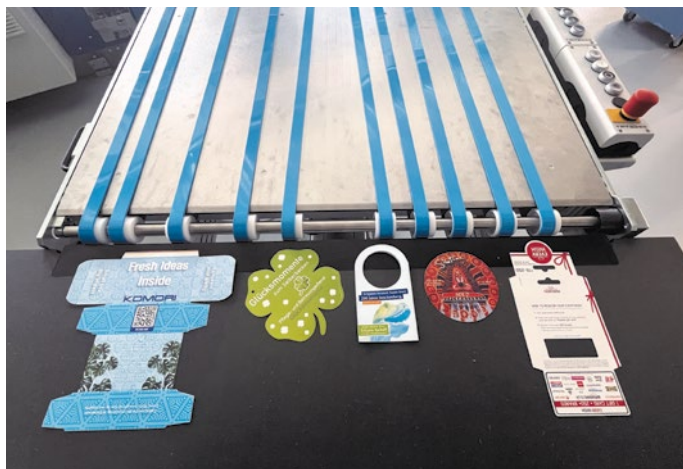
Bograma zeigt eine Inline-Lösung für das präzise Stanzen vielfältiger Digitaldruckprodukte sowie deren effizientes Schuppen, Spreizen und Auslegen.
