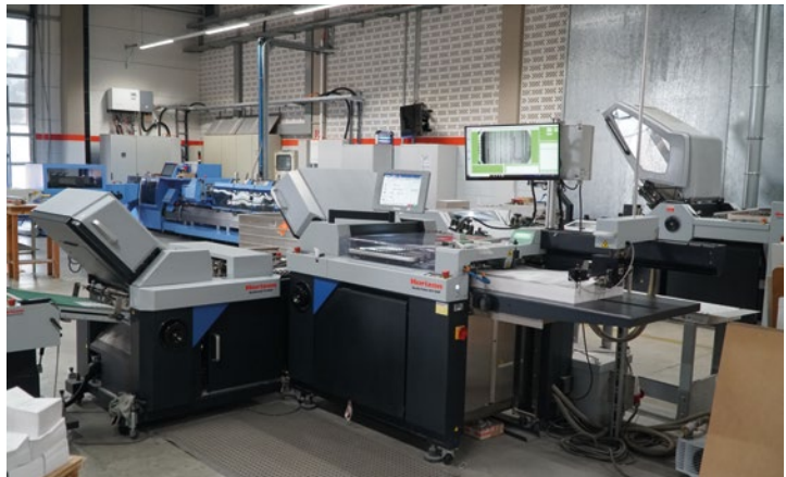
Die Horizon AFV-566F mit nachgelagerter Falzeinheit TV-566F. Der Monitor über der Anlage zeigt das Live-Bild des kvInspect-Systems, das jeden Bogen vor dem Falzen erfasst.
