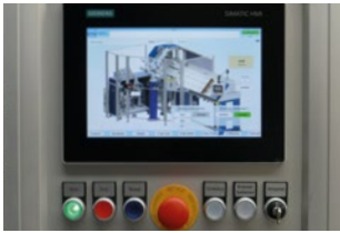
Die systemische Darstellung am Anwender-Display des iPack erleichtert die Bedienung.
