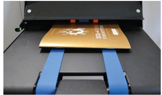
Alles in einem Arbeitsgang: Ausgabe einer fertigen Broschüre an der Plockmatic BK 435e.
