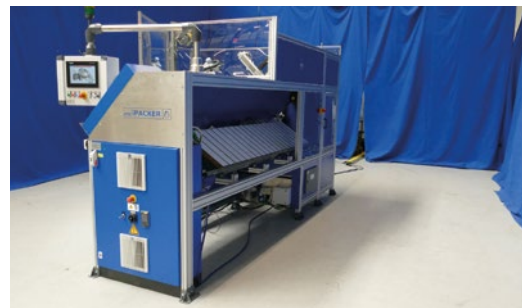
Das Ausschleuse- und Stichprobenmodul iChecker (I.) mit integriertem Kamerasystem prüft die Produkte während des laufenden Prozesses und kann fehlerhafte Exemplare automatisch ausschleusen. Der iPack (r.) im Showroom bei ETU.
