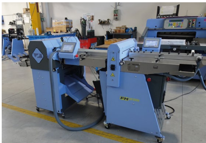
Sehr kompakt mit nur 300 cm Länge ist die „Butterfly 2 Glue“ in Linie mit der Rillmaschine FM16000.
