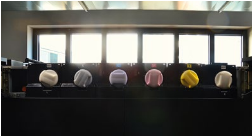
Das Sechsfarbwerk der Revoria Press PC2120 ermöglicht bei creat einen deutlich vergrößerten Farbraum durch den Einsatz von Pink und Grün.
