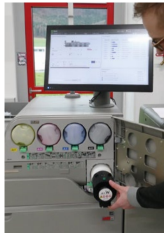
Ein schneller Wechsel des Sonderfarben-Toners schafft großen kreativen Spielraum bei der Produktion.
