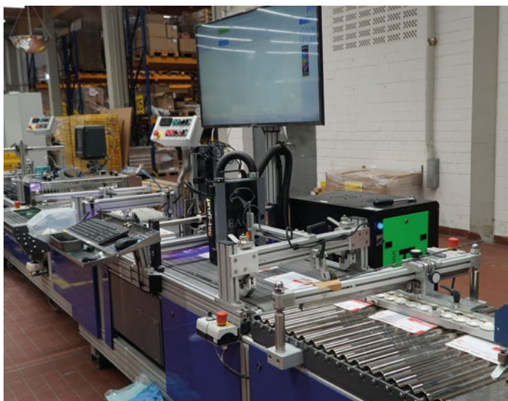
Hybridproduktion in voller Geschwindigkeit: Staub und Puderreste aus dem Offsetdruck können den robusten Eagle-Druckmodulen nur wenig anhaben. Störungen konnten so minimiert und die Leistung deutlich erhöht werden.
