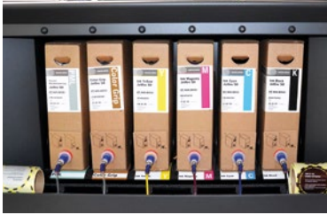
Oben: Die übersichtliche Versorgungseinheit auf der Rückseite des Drucksystems Rechts: Die Heidelberg Jetfire 50 steht für moderne, digitale Produktionsmöglichkeiten im B3-Format und ergänzt das Portfolio zukunftsweisend.
