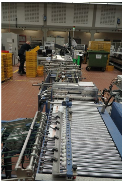
Jeden Tag konfigurieren die Mitarbeitenden im Sattler-Lettershop ihre Produktion nach Bedarf neu. Hier werden Nutzen vereinzelt und vor dem Druck ausgerichtet.
