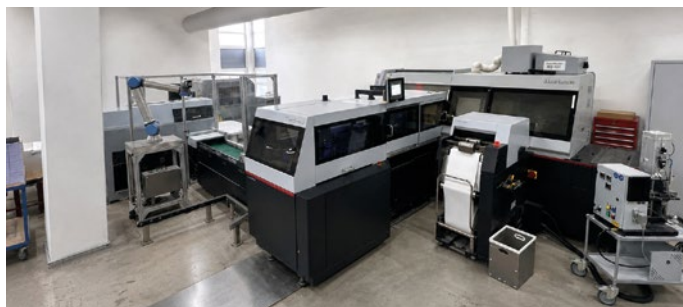
Ideal für die vollautomatische, variable Buchproduktion und personalisierte Produkte: Horizon Smart Binding System bestehend aus ICE Binder BQ-500 mit Gazezuführung GF-500, Vorsatzanleger ESF-1000 und Dreimeßer-Vollautomat HT-1000V.
