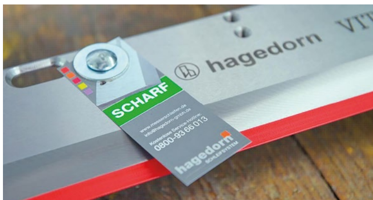
Von hagedorn wiederaufbereitete Kanefusa-Hartmetallmesser der Marke Vitech: Die nachgeschliffenen Messer sollen mindestens die Standzeit der ursprünglichen Herstellerqualität erreichen, so die Zielvorgabe bei der hagedorn GmbH.
