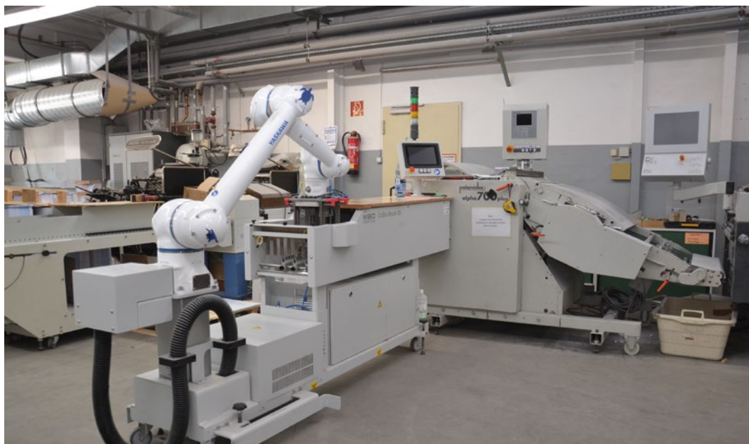
Die gefalzten Produkte am Ausgang dieser palamides alpha 700 plus werden nun von einem MBO/Komori CoboStack 10i entnommen und präzise abgestapelt.
