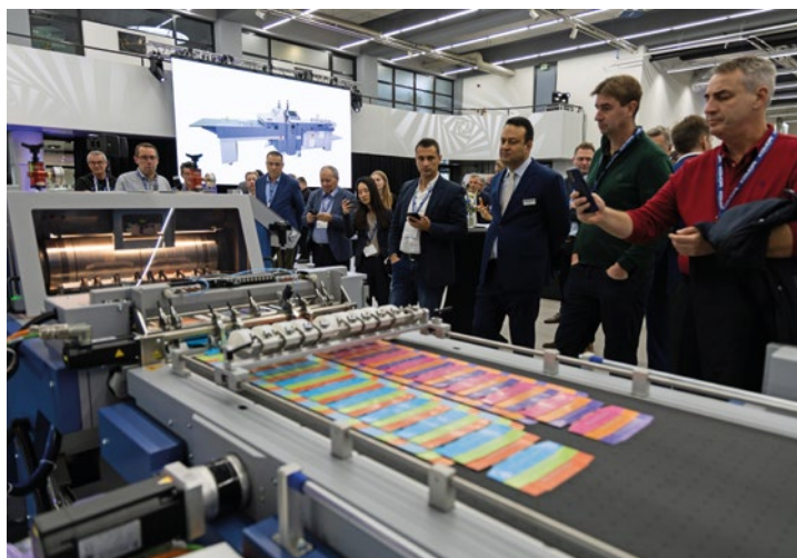
Rotative Stanztechnologie von Bograma (hier die Bograma BSR 550 Servo) – entwickelt für höchste Präzision, kurze Rüstzeiten und wirtschaftliche Produktion.
