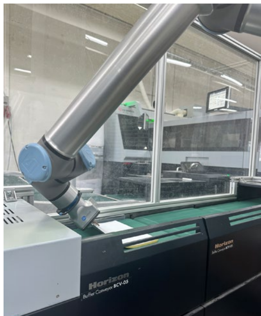
Loseblattsammlungen werden dem Horizon Smart Binding System per kollaborierendem Roboter zugeführt.
