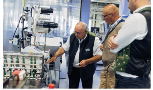
R&T Inline Labeling Unit heißt die neue Inline-Etikettier-einheit für das präzise Verschließen mit Labels.
