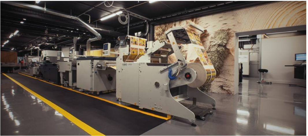
Abwickler, Querschneider und Falzaggregat von MBO als Teil einer vernetzten Inline-Digitalverarbeitungs-Linie...
