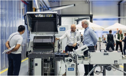
Ein neues Wendemodul von GUK ermöglicht das flexible Drehen oder Durchschleusen der Falzprodukte.
