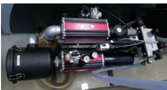
Das Piab-Pumpensystem erzeugt Vakuum und Blasluft deutlich leiser und verbessert damit die Arbeitsbedingungen.
