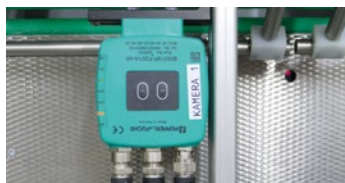
Kamera 1 des Eagle-Systems von PPL am Umschlaganleger kontrolliert per Bild- und Barcode-Erkennung.
