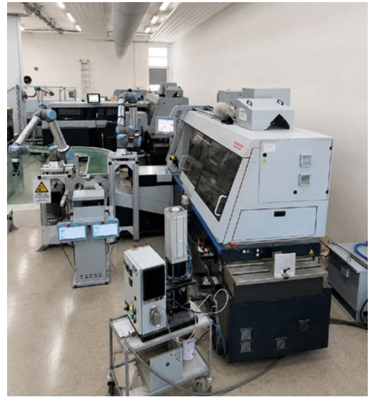
Die Horizon Klebebinde BQ-480 und BQ-500 sorgen bei der Digital Print Group für eine zuverlässige und flexible Buchproduktion mit kurzen Rüstzeiten und sehr hoher Prozesssicherheit.
