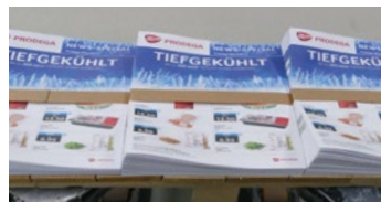
Fertig geheftet und banderolierte Broschüren. Der Kreuzleger des ST 500 sorgt für hohe Stapelqualität.
