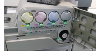
Die fünfte Farbstation (rechts unten) der Pro C7500. Bei Blaich kommen Weiß und Gold zum Einsatz.
