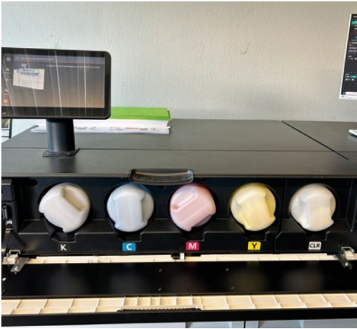
Fünf statt vier Farbstationen: Neben CMYK verfügt die Revoria Press EC2100S bei Friedrich über eine zusätzliche Station für Klarlack (CLR).
