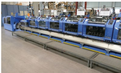
Einer der beiden Sammelhefter Primera Pro von Müller Martini. Sie sind wichtiger Bestandteil im Produktionsfluss.
