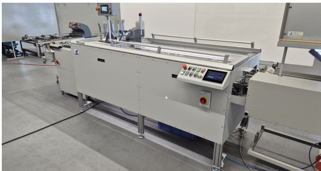
Prozess-Know-how im Sondermaschinenbau: MKW-Zusatzeinheit zur Realisierung einer Inline-Kalenderproduktionslinie.
