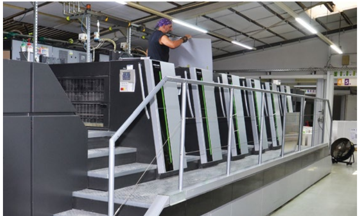
Blick auf die Speedmaster XL 106-5+L, die mit modernster Inline-Veredelung und einem der weltweit ersten Digital-Infeed-Systeme überzeugt.
