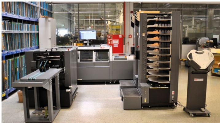
Die FKS/Duplo iSaddle bei O.D.D. Print + Medien: Das Broschüren-System verknüpft digitale Flexibilität mit der Heft- und Schneidetechnik einer Großanlage.
