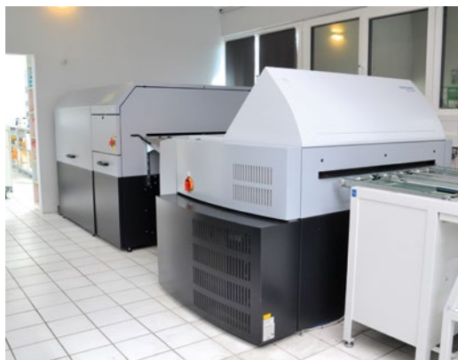
Effizienter Start in die Produktion: Der Suprasetter 106 APL sorgt bei Kern Druck für eine spürbare Zeitersparnis bei der Plattenbelichtung.
