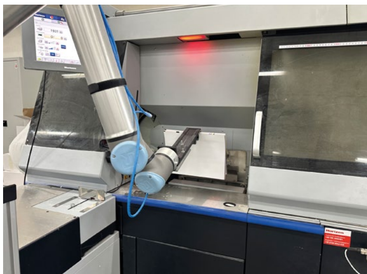
Ohne manuelle Eingriffe: Auch die Buchblock-Zuführung am BQ-480 erfolgt per Roboterarm.
