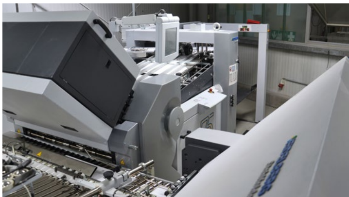
Effiziente Weiterverarbeitung: Der neue Stahlfolder TH 82-8/6/4 sorgt mit acht Falztaschen im ersten Falzwerk für maximale Flexibilität.
