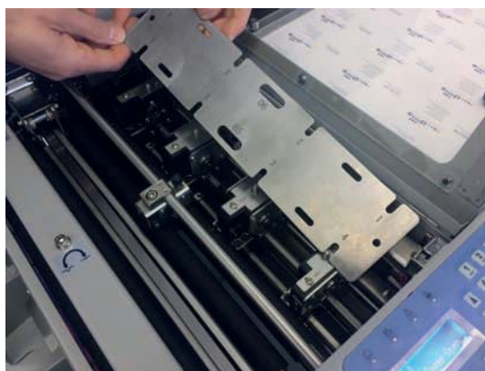
Anhand des definierten Lochbildes einer Schablone werden die Längsmesser an die richtige Stelle bewegt.
