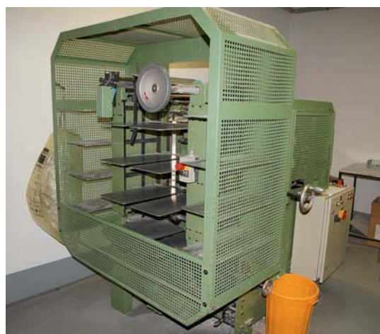
Die vorhandene Kugler-Stanze wurde überholt und wird heute beim DBM zusammen mit einer gebrauchten Zusammentragmaschine für die neue Drahtkammbindung-Produktion bis zum Format DIN A3 eingesetzt.
