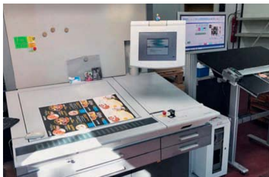
Der Leitstand zeigt die LithoFlash-Anzeige rechts neben dem Leitstandsmonitor.
