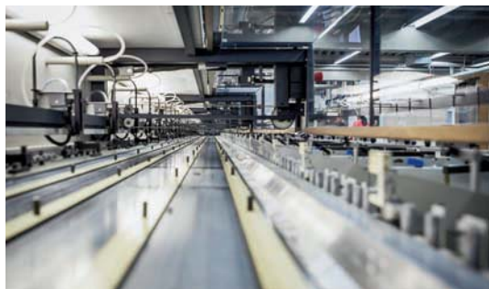
24 Stationen, zwölf Meter lang – so lauten die Eckdaten des Bandtransporttisches der Zusammentragmaschine tb flex B 324 HP.
