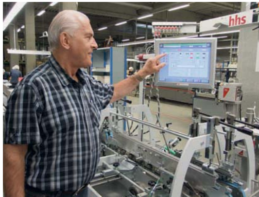
Hans-Peter Blockus steuert die gesamte Technik von Baumer hhs für Leimauftrag und Qualitätskontrolle über den zentralen Bildschirm des Xtend 2 -Systems.
