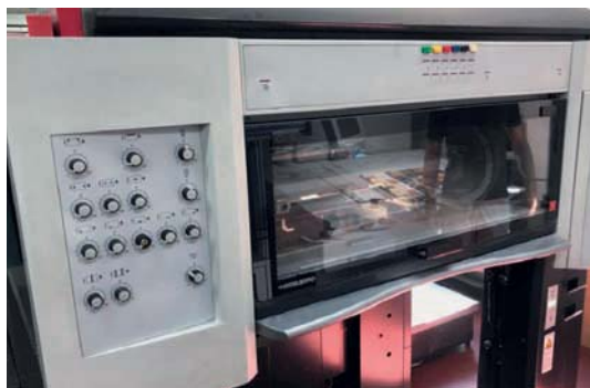
In der Auslage der Maschine sind alle Bögen schon gemessen und geregelt.
