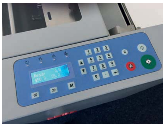
Programmiert wird der Kartenschneider Gemini Cut über ein Display und eine Filmtastatur.
