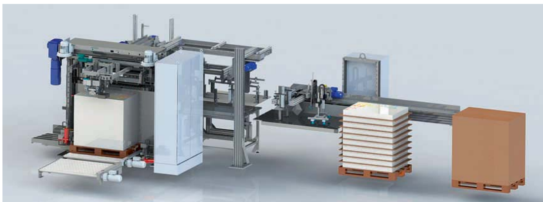
Schüttel-System Omega: vollautomatische Offline-Materialvorbereitung bei der Etiketten-/Akzidenzenproduktion.
