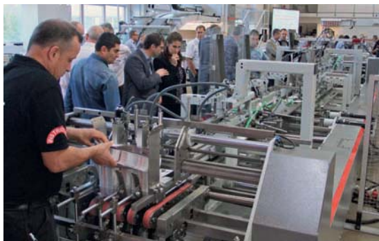
Eine Präsentverpackung wurde mit der Faltschachtel-Kle- bemaschine Expertfold 110 A2 gefaltet, geklebt und am halbautomatischen Abpacker Handypack GT verpackt.
