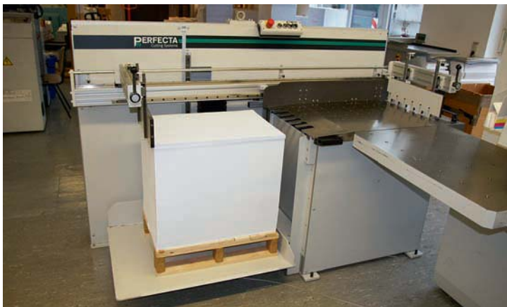
Der Ablader BA 2 Ne von Perfecta ermöglicht jetzt bei der Druckerei Nauendorf das zügige Absetzen von geschnittenen Lagen während des Schneidprozesses. Das sichert eine hohe Stapelqualität.
