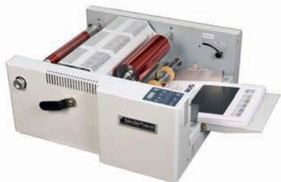
Mit einem Reibanleger veredelt die Foil-Tech FT-12F automatisch den angelegten Papierstapel.
