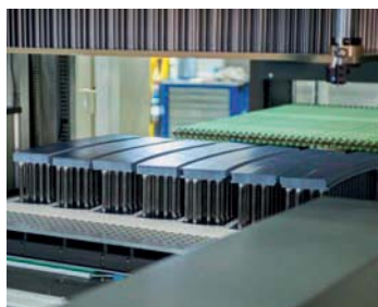
Nutzentrennung von IML-Etiketten mit dem Laserck Master Blanker.
