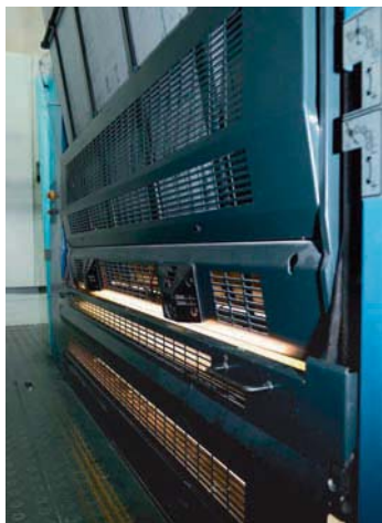
Optimierter Plattenwechsler mit Plate-Ident-Kameras an einer der Rapida 145.
