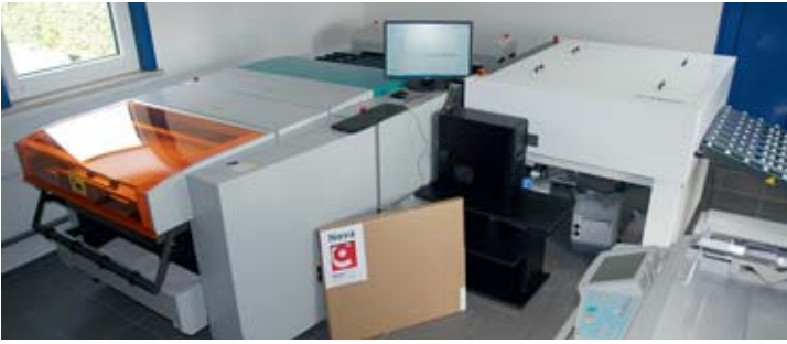
Das neue CtP-System Cron TP-3632G mit Autoloader für drei Kassetten produziert mit 32 Dioden (bis 128 aufrüstbar) rund 30 Platten pro Stunde.
