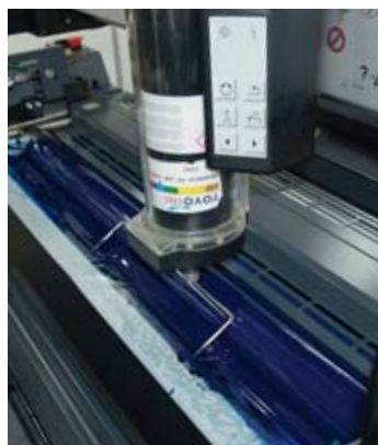
Die UV-Farben von Toyo bleiben im Farbwerk immer in Bewegung. Eintrocknen und Reinigen entfällt.
