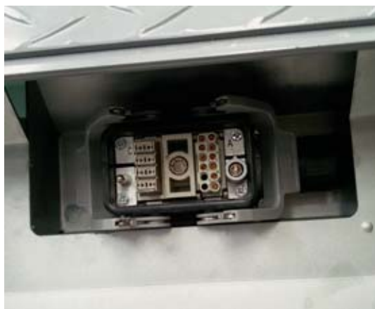
Über eine Steckverbindung kann LithoFlash Inline einfach in die Maschine integriert werden.
