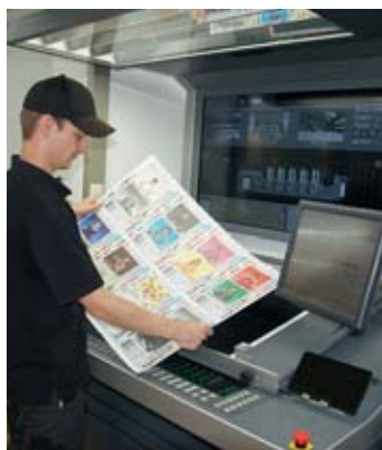
Ein großer Monitor am Leitstand zeigt alle Funktionen der RMGT 925 nebst Kameraüberwachung.
