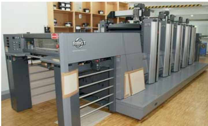
Die RMGT 925 LED UV: Neues Design, neuer Anlegekopf mit hoher Performance, veränderter Farbfluss durch eine neue Walzenkonfiguration und vieles mehr erlauben Müller Offset Druck rund 30 bis 40 Prozent mehr Output.
