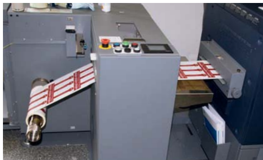
Von Rolle-zu-Rolle arbeitet die Konica Minolta bizhub Press C71cf im CMYK-Modus mit bis zu 18,9 m/min in einer Auflösung von 1.200 x 1.200 dpi / 8 bit.
