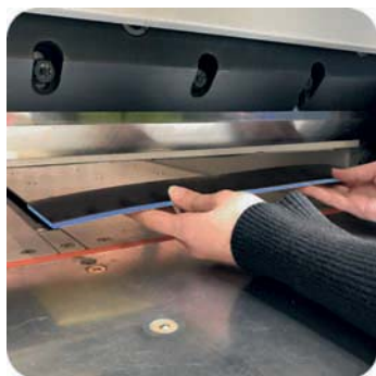
Die magnetischen Schneidschutzleisten MagPad schützen empfindliche Materialien im Stapelschneider.
