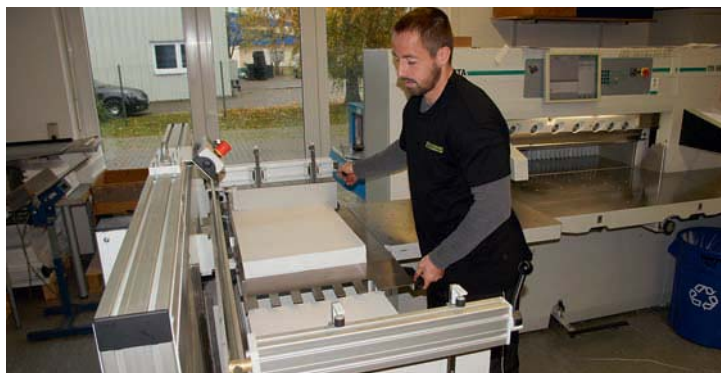
Mitarbeiter Sebastian Koch schätzt die einfache Handhabung der automatischen Formateinstellung. Zudem spart er dank verbesserter Ergonomie Zeit und Kraft gegenüber der alten »Hubwagen-Lösung«.
