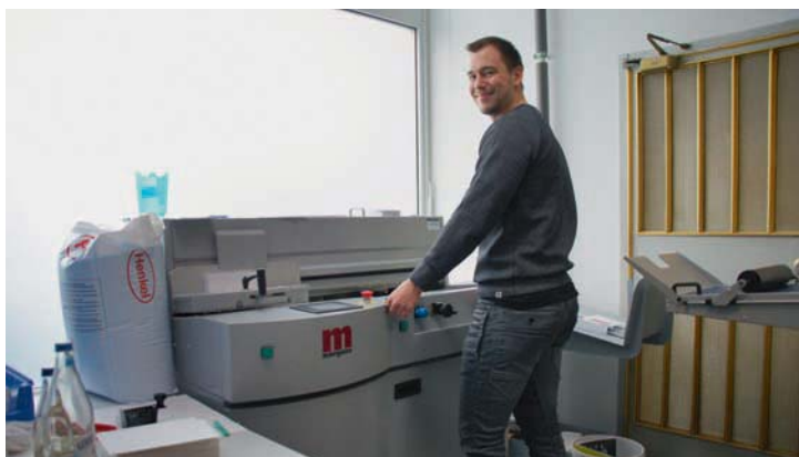
PPP-Mitarbeiter Conor Merkel an der neuen Morgana Digibook 150 PUR: »Wir weisen die Kunden immer darauf hin, ab wann die Bindung voll belastbar ist. Der PUR-Kleber muss ja erst aushärten.«
