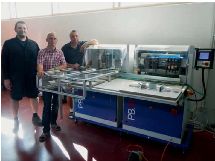
»Der Kalenderprofi – PB.1618« von Dürselen – im Einsatz bei Rabl-Druck in Schrems (Österreich). Hierbei handelt es sich um die durch einen Systemtisch vernetzten Dürselen-Papierbohrmaschinen PB.16D und PB.18.
