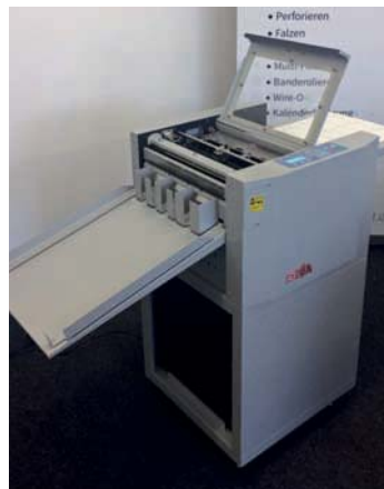
Der Gemini Cut ist ein kompakter Kartenschneider mit Rillfunktion für kleinere Digitaldruckanwender und Copyshops.
